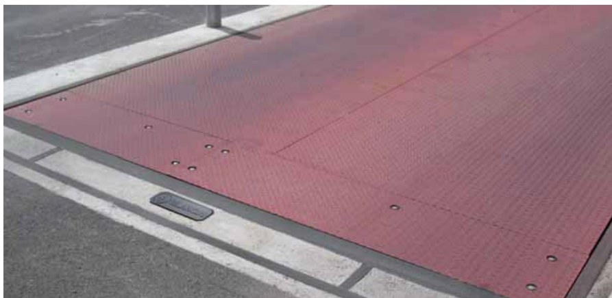
Fig.7 – Pesa a ponte interrata
