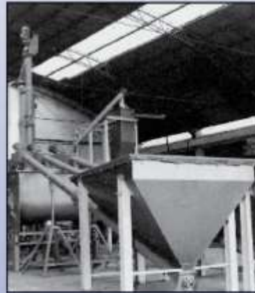
SCREW CONVEYOR FOR CHEMICALS DÖRERSCHNITT FÜR CHEMISTAN VIS TUBULAIRE POUR PRODUITS CHIMIQUES COGLIERE PER PRODOTTI CHIMICI
