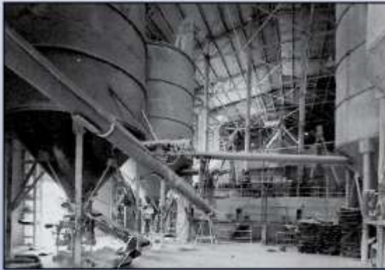
SCREW CONVEYOR FOR TRANSPORT OF RAW MATERIALS FOR CERAMIC GLAZES FÖRTRANSPORTVORRICHTUNG FÜR ROHSTOFFE FÜR KERAMISCHES ZUGBENUTZUNG VIS TUBULAIRE TRANSPORT MATIÈRES PREMIÈRES POUR LAQUELS CÉRAMIQUES COGLIERE TRANSPORT BRUTS POUR MATIÈRE CÉRAMIQUE
