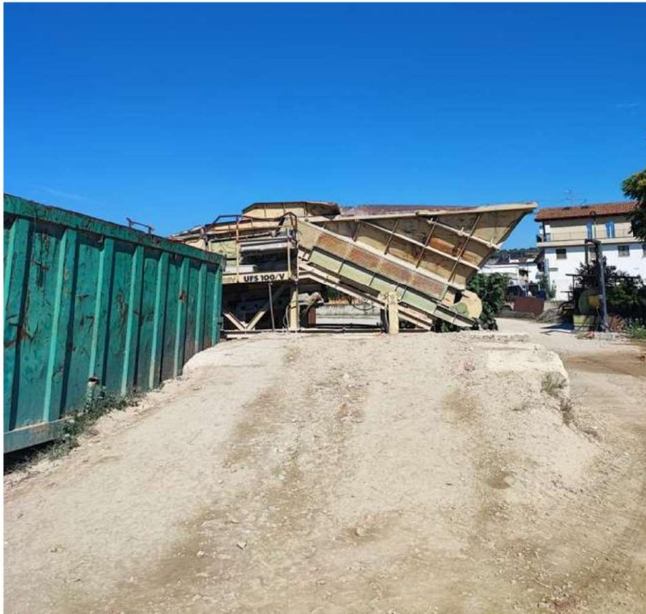
Il gruppo di frantumazione è dotato di separatori magnetici, per la separazione della frazione metallica presente nel materiale macinato
