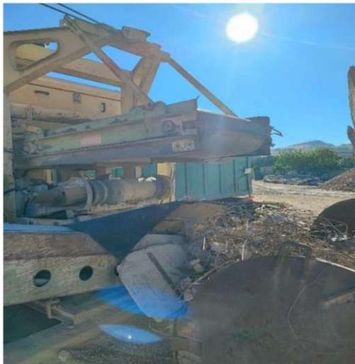
e di un sistema di spray di acqua posto sulla bocca del mulino per la riduzione della polverosità nella fase di frantumazione
